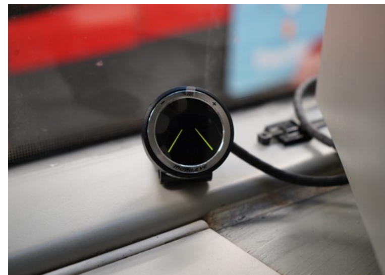
Die Eye-Watch zeigt vorausliegende Objekte an und gibt bei drohenden Kollisionen eine akustische Warnung ab. © Wiener Linien
