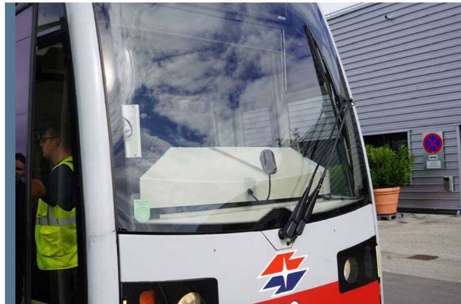
Das Kamerasystem wird an der Frontscheibe der Straßenbahn angebracht, ohne dabei das Sichtfeld einzuschränken. © Wiener Linien
